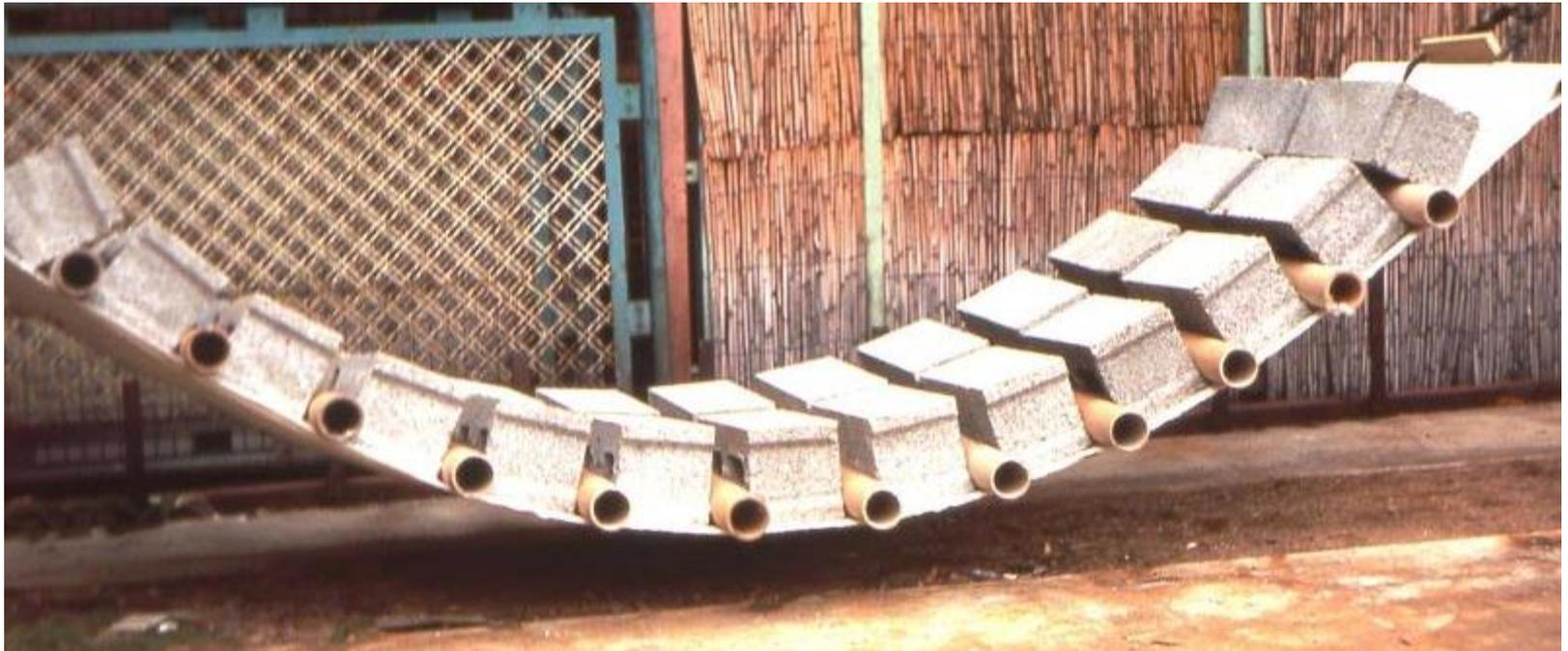
Le sol mou étant peu portant, le poids du remblai est transféré sur des pieux, via la nappe géosynthétique fonctionnant en « membrane »
